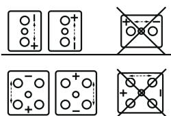
Si es necesario, limpiarlas con un cepillo de latón. No invierta la posición de los elementos (conductos de ventilación boca abajo). No colocarlos de modo que la parte frontal esté más baja que la base del elemento ya que se dañaría la válvula de seguridad y podríamos causar daños irreparables. Apretar las tuercas utilizando
