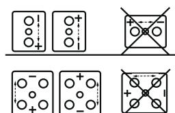
Ne pas inverser les éléments (système de dégazage à l'envers). A aucun moment le haut des éléments ne doit être positionné plus bas que la base des éléments car ceci pourrait boucher les valves de sécurité et endommager les bornes. Contrôler que toutes les surfaces de contact sont propres. Si nécessaire, nettoyer avec une brosse laiton. Serrer les écrous en prenant soin
